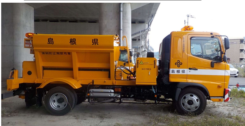
凍結防止剤散布車（凍結した路面を溶かします）
